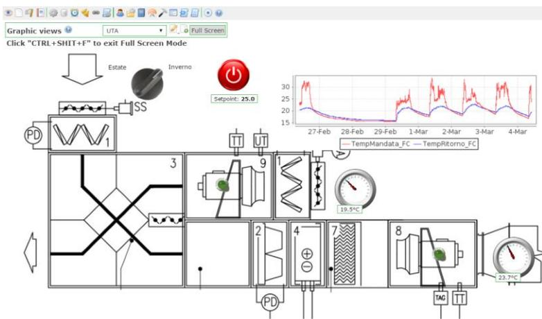
WebVisor è un completo sistema di supervisione e controllo (SCADA) via WEB dove è presente all'interno dello stesso software sia l'ambiente di sviluppo del sistema di acquisizione, sia il runtime di gestione dei dati interrogabile da PC, tablet o smartphone.
