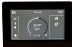
Regolatore digitale liberamente programmabile per installazione su scatola 503 con display grafico 800x480 punti dotato di touch screen e sonde temperatura/umidità e qualità dell'aria (versione QA). Il regolatore è in grado di svolgere articolate funzioni HVAC (es. gestione pannelli radianti con deumidificazione e VMC).
