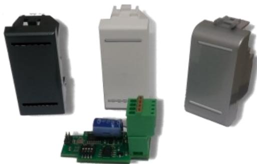
Sonda da incasso in scatola 503 su singolo modulo con sensore temperatura/umidità. E' dotata di dip switch per la selezione dell'indirizzo bus e di sofisticati algoritmi per la gestione del riscaldamento/raffrescamento. La porta seriale Modbus Rs485 consente di leggere e comandare a distanza le funzionalità.
